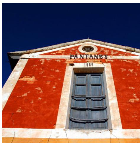
**VA** El Pantanet són dos construccions, una és un embassament xicotet. Està situat en la capçalera del regadiu, emmagatzema les aigües en un depòsit de 200 metres de longitud, 40 m d'ample i una profunditat de 2 a 3 metres. Des del depòsit partixen braçals que distribueixen les aigües per l'horta. Construït en 1842, encara hui conserva la seua utilitat per a regular les eixides d'aigua amb què es rega l'horta.
